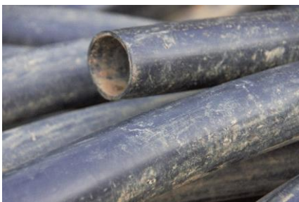
Tuyaux de mauvaise facture
